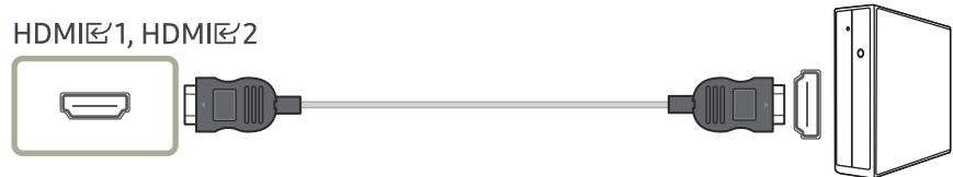
— Il est recommandé d'utiliser le câble HDMI fourni. S'il n'est pas fourni, utilisez un câble homologué pour les connexions de câble HDMI. Si vous utilisez un câble HDMI non homologué, la qualité de l'image risque de se détériorer.
