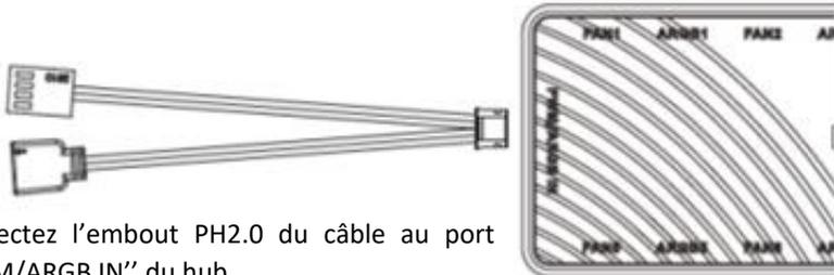
Connectez l'embout PH2.0 du câble au port "PWM/ARGB IN" du hub.
