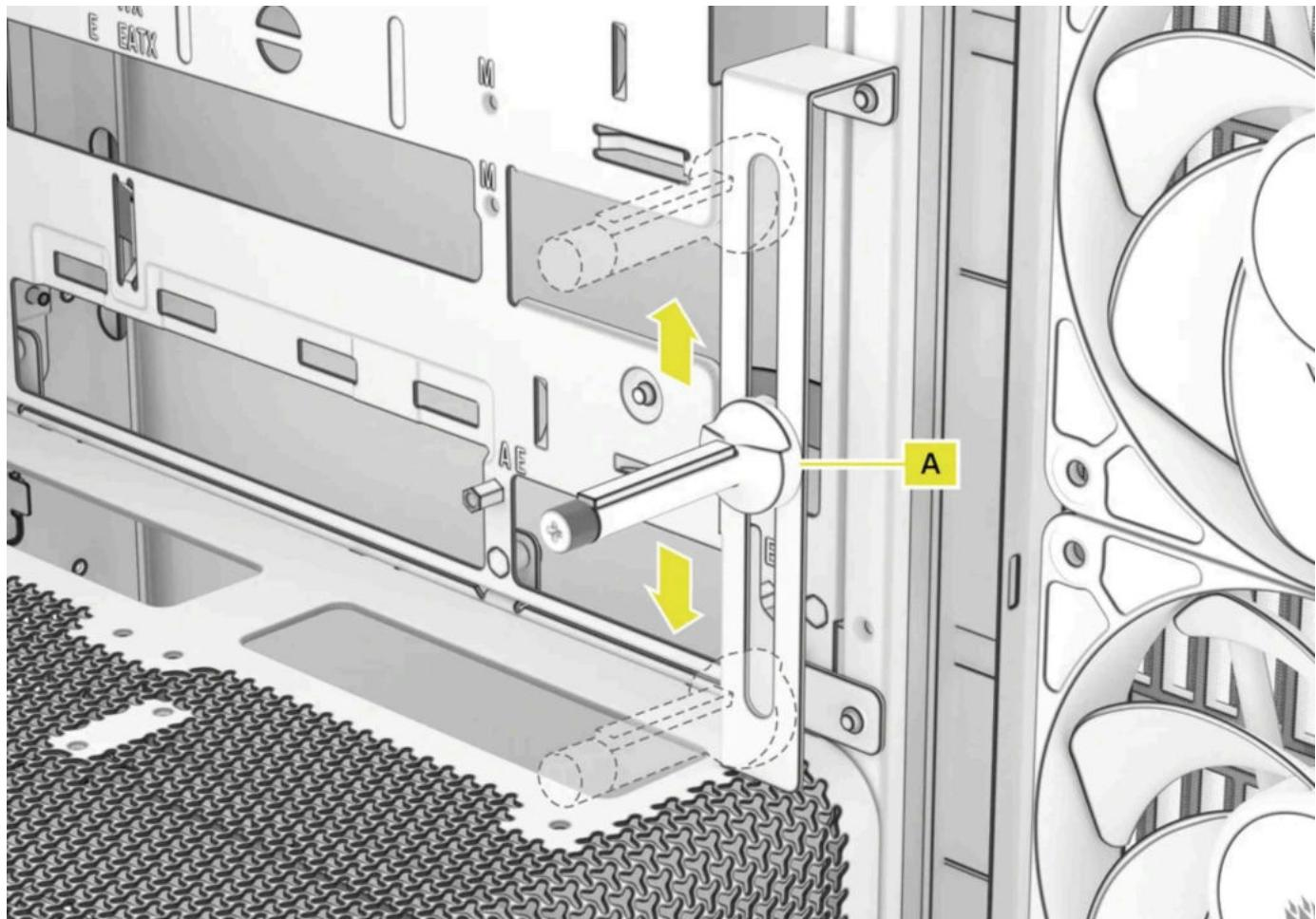
Si le ventilateur de votre GPU ou d'autres pièces entrent en contact avec le bras en caoutchouc, utilisez les entretoises en caoutchouc pour bras de stabilisation anti-affaissement (**2**) fournies dans la boîte d'accessoires afin de garantir un dégagement suffisant par rapport aux pièces mobiles.
