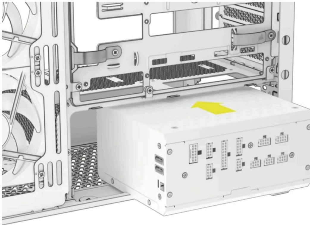
**CONSEIL :** Le FRAME 4500X a été conçu pour être compatible avec CORSAIR SHIFT, ce qui signifie que tous les blocs d'alimentation CORSAIR SHIFT sont entièrement compatibles et offrent suffisamment d'espace pour plier et acheminer les câbles vers les emplacements nécessaires.
