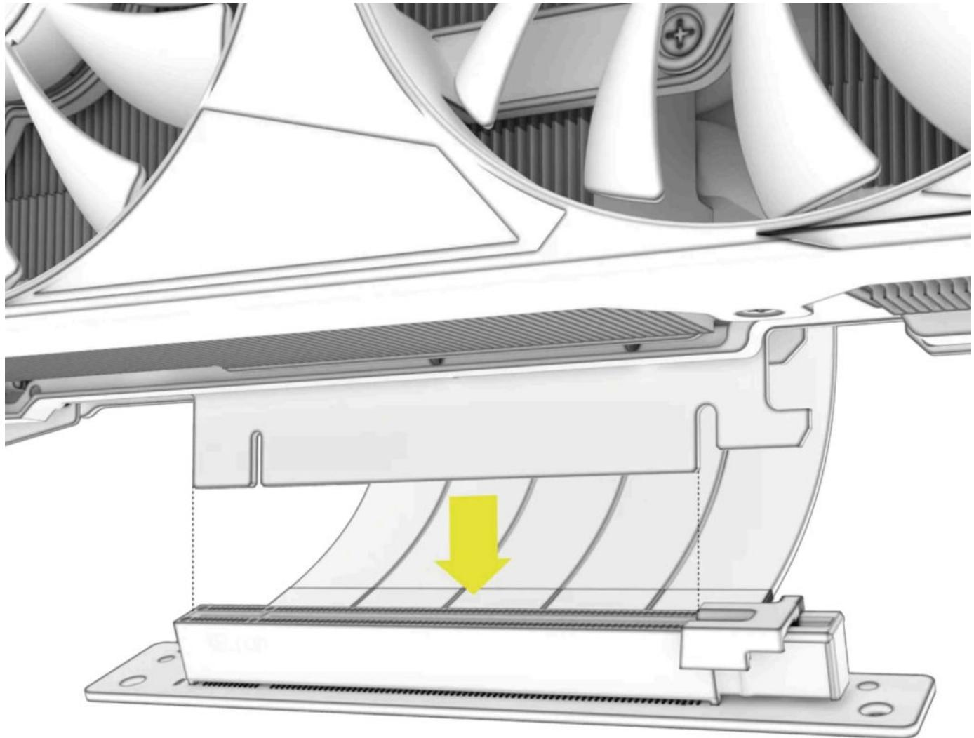
**IMPORTANT :** pour une expérience optimale, assurez-vous que votre GPU est suffisamment éloigné de la vitre et qu'il n'est pas comprimé par le riser PCIe.
