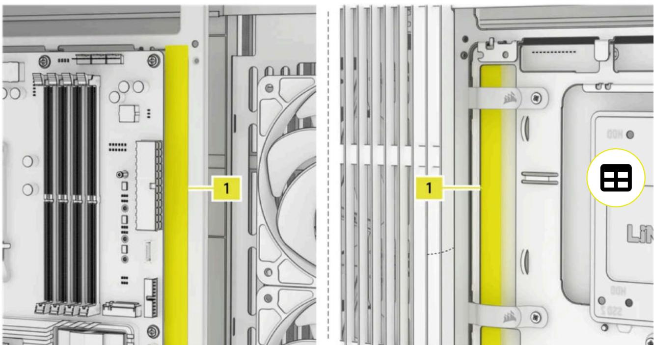
**CONSEIL :** la bande magnétique est dotée de fentes découpées, ce qui vous permet de l'installer simultanément avec un support de bras anti-affaissement et de la faire glisser pour obtenir un ajustement parfait, quelles que soient les tolérances du port de la carte mère.
