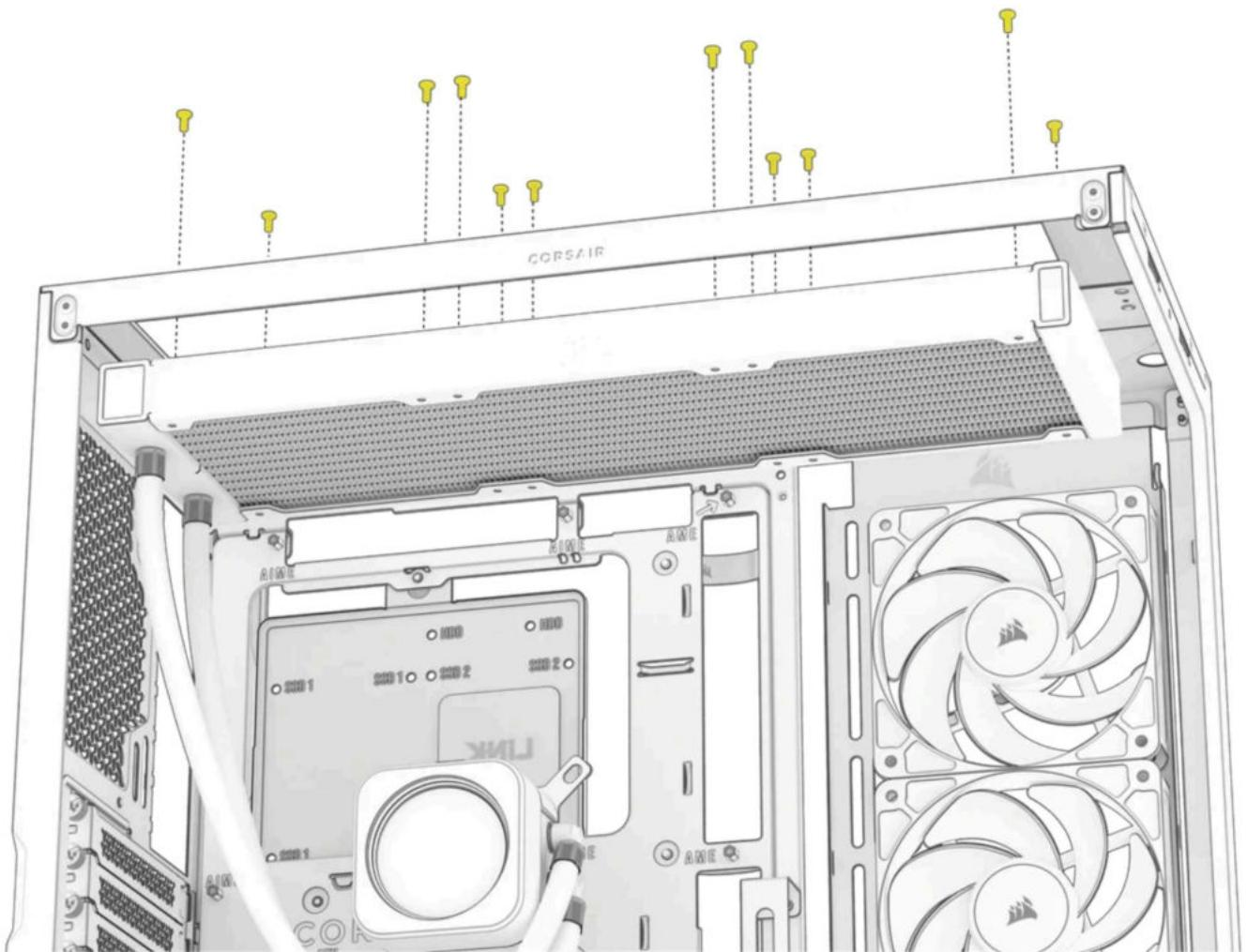
Avec les vis de montage appropriées, les radiateurs peuvent également être installés de manière sécurisée sur le côté du boîtier.
