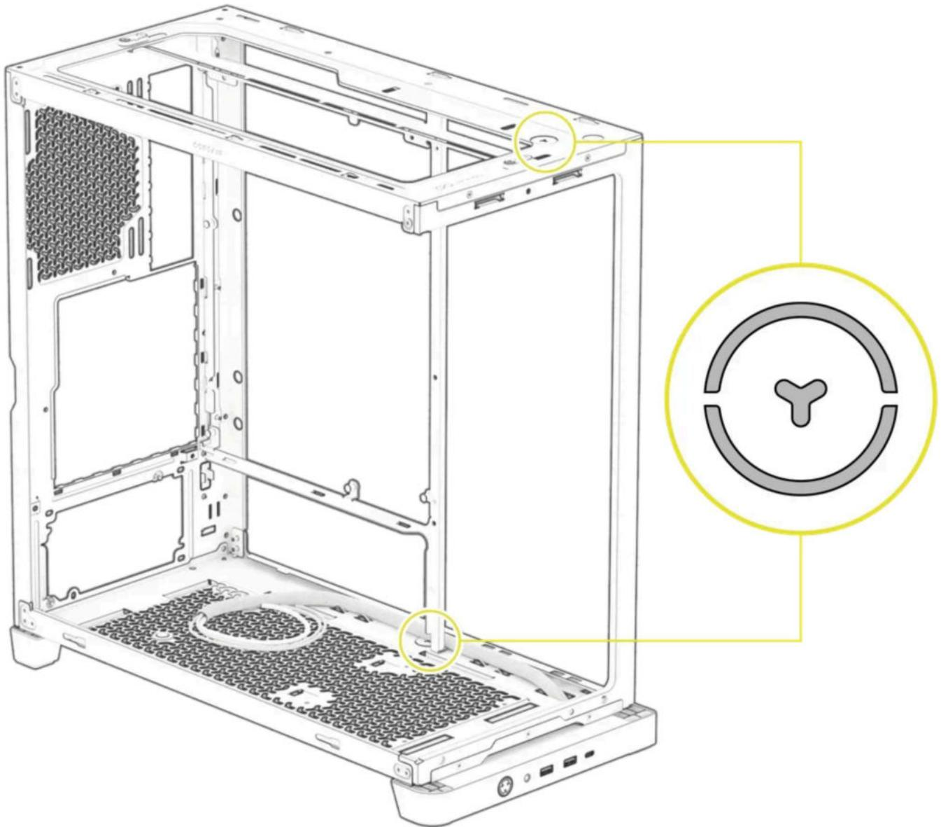
**CONSEIL :** Le port de remplissage inférieur peut être utilisé comme point d'entrée alternatif pour les E/S du panneau avant afin d'obtenir un aspect plus net.
