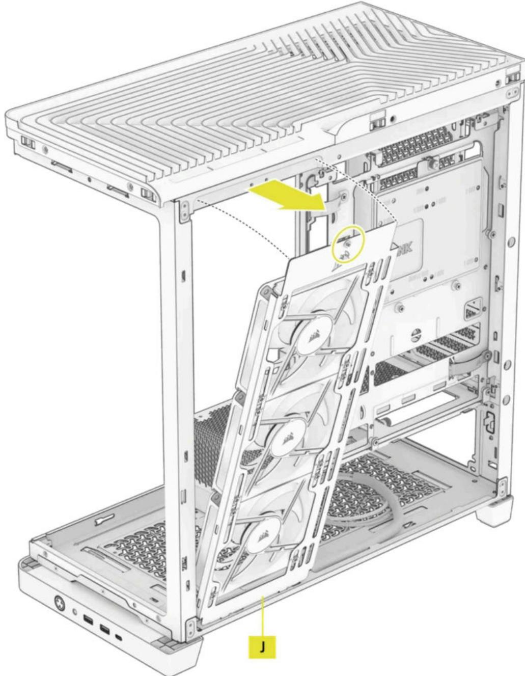
**REMARQUE :** Le support de ventilateur latéral (J) prend en charge les ventilateurs de 120 mm et 140 mm. Pour plus d'informations sur la prise en charge des ventilateurs à différents emplacements, veuillez consulter la section consacrée au montage des ventilateurs ci-dessous.
