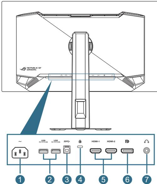
1. **Port ENTRÉE CA** : Ce port est utilisé pour brancher le cordon d'alimentation.
