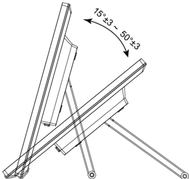
Figure 3. Ajustement de l'inclinaison
