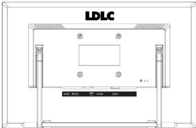
1. Veillez à acheter un support mural adapté aux dimensions et au poids de votre appareil. Il doit en outre posséder la même norme VESA que celle de votre appareil :
