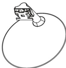
3. Coloque la parte superior del marco de la base plana en la ranura del lado inferior de la caja posterior y pégalo a ella, luego empuje hacia arriba para insertar el soporte de la base en la caja posterior.
