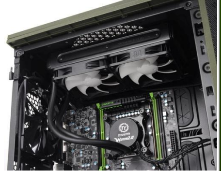
Compatible avec système de refroidissement à eau pour radiateurs internes de 120 & 240mm
